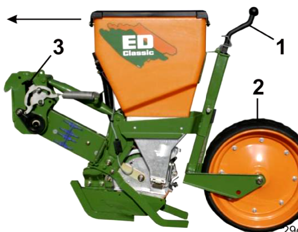
1 – рукоятка регулировки глубины заделки семян; 2 – колесо прикатывающее; 3 – пружина нажимная
