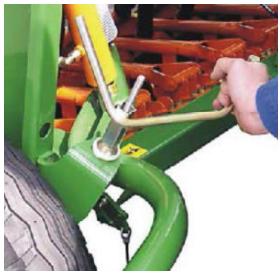
Рисунок 7 – Централизованная регулировка давления на сошник
