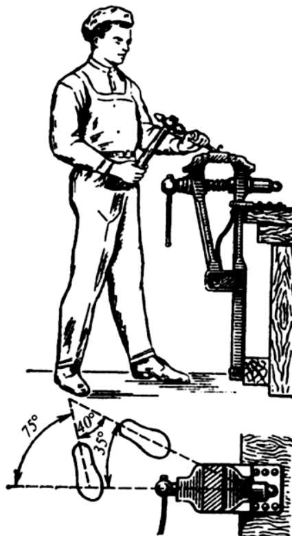
Рисунок 5 - Рабочее положение при рубке.
