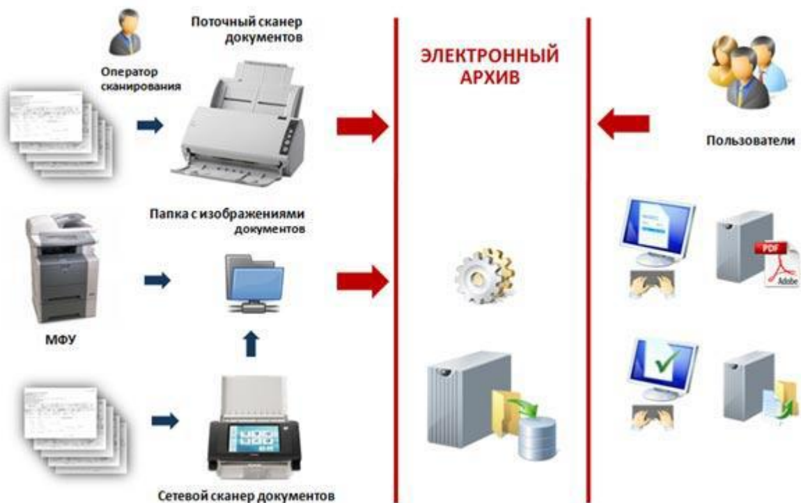
Рисунок 23 – Типовая схема организации электронного архива документов
