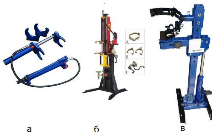
а – переносная стяжка пружин АЕ&Т (КНР) модели Т01401; б – универсальный стенд JTC-JL9511 (Тайвань); в – стяжка для пружин напольный XC0301C
