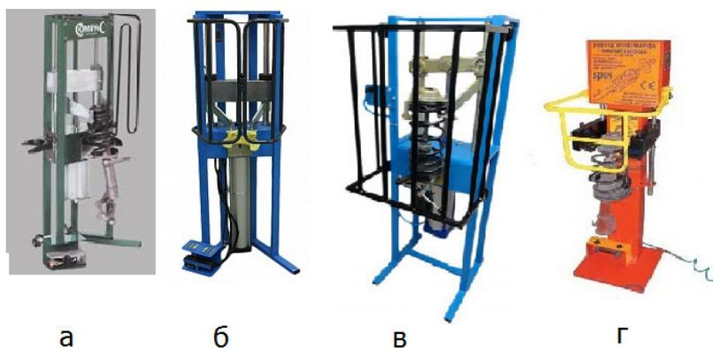
а – стяжка пружин стационарная Compras CSC (Дания); б - стяжка пружин макферсона с пневмоприводом СТ-G0108; в – универсальная установка СТ-G0108U; г – пневматический пресс для разборки амортизаторов SS0010 Compact3
