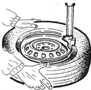
Рисунок 1.3 - Монтаж покрышки на обод колеса (забортовка)
