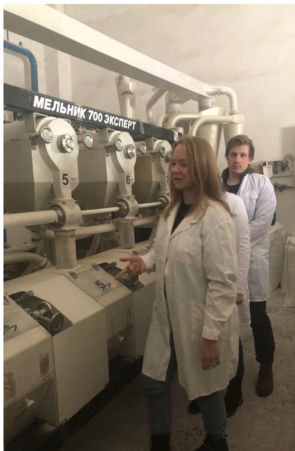
Рис. 2 Вальцовая мельница МЕЛЬНИК 700 ЭКСПЕРТ
