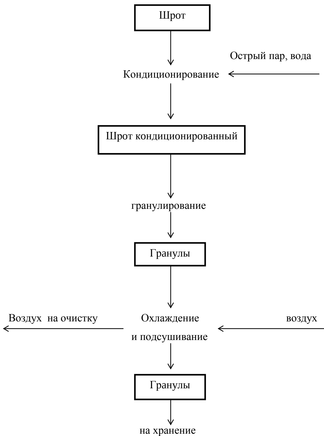
Схема 3. Поток сырья на участке гранулирования шрота
