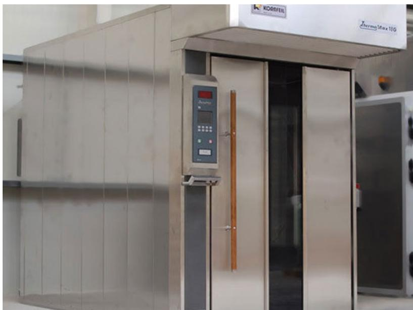
Рисунок 4 - Тележечная печь ThermoMax
