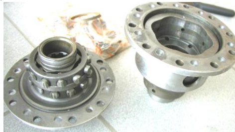
а – схема устройства, б – схема работы, в – внешний вид. 1 - внутренняя звездочка; 2 - сепаратор; 3 - наружная звездочка; 4 - чашка дифференциала; 5 - сухарь Рисунок 6.15 - Кулачковый дифференциал автомобиля ГАЗ-66
