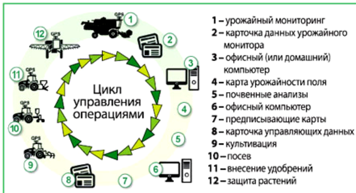
Рисунок 5 – Циклограмма точного (координатного) растениеводства
