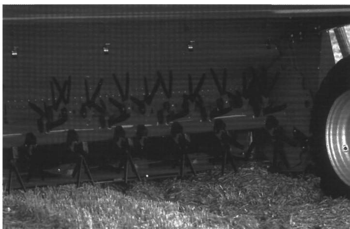
Рисунок 1.8 Косилка-плющилка с динамическим плющильным аппаратом и полужестко закрепленными бичами
