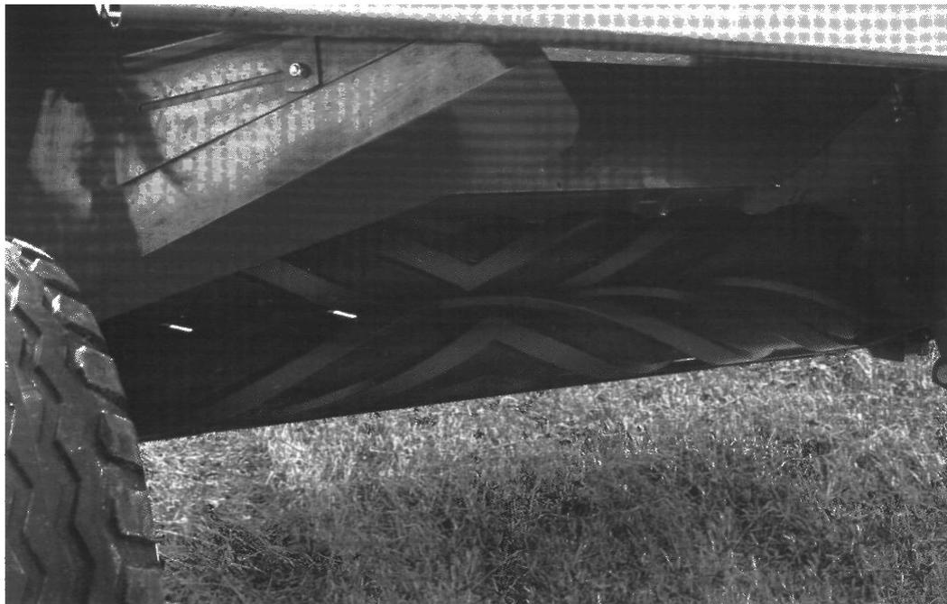
Рисунок 1.5 Косилка-плющилка с прорезиненными вальцами
