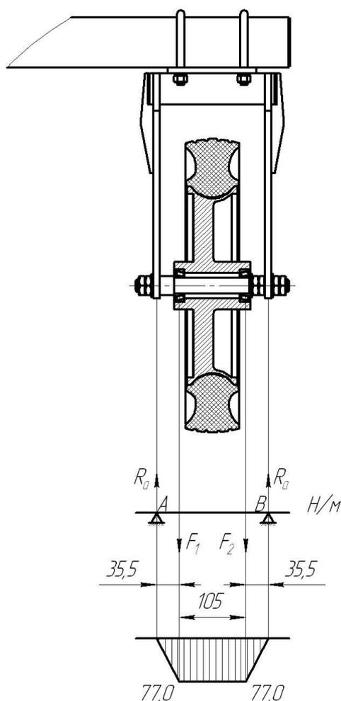
Рисунок 3.5 – схема сил действующих на опорное колесо
