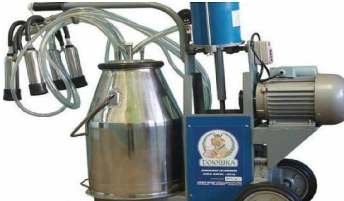
Рисунок 1.1 - Фото доильного аппарата Доюшка
