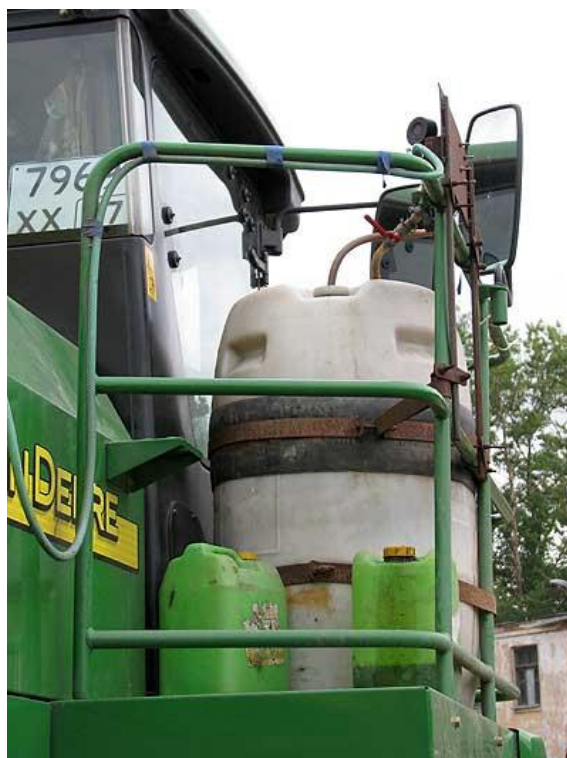
Рисунок 1.4. Схема размещения емкости с биопрепаратом на кормоуборочном комбайне Джон-Дир
