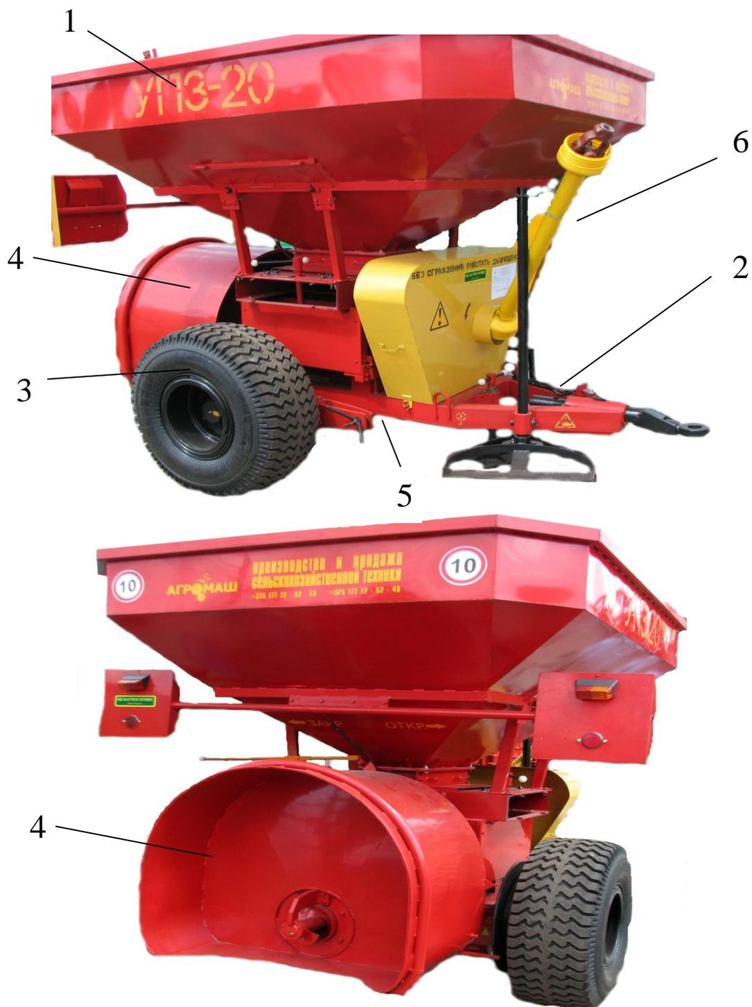
1 – Бункер; 2 – Рама , 3 – Шасси; 4 – Выгрузной фартук; 5 – Система тормозная; 6 – карданный вал.
