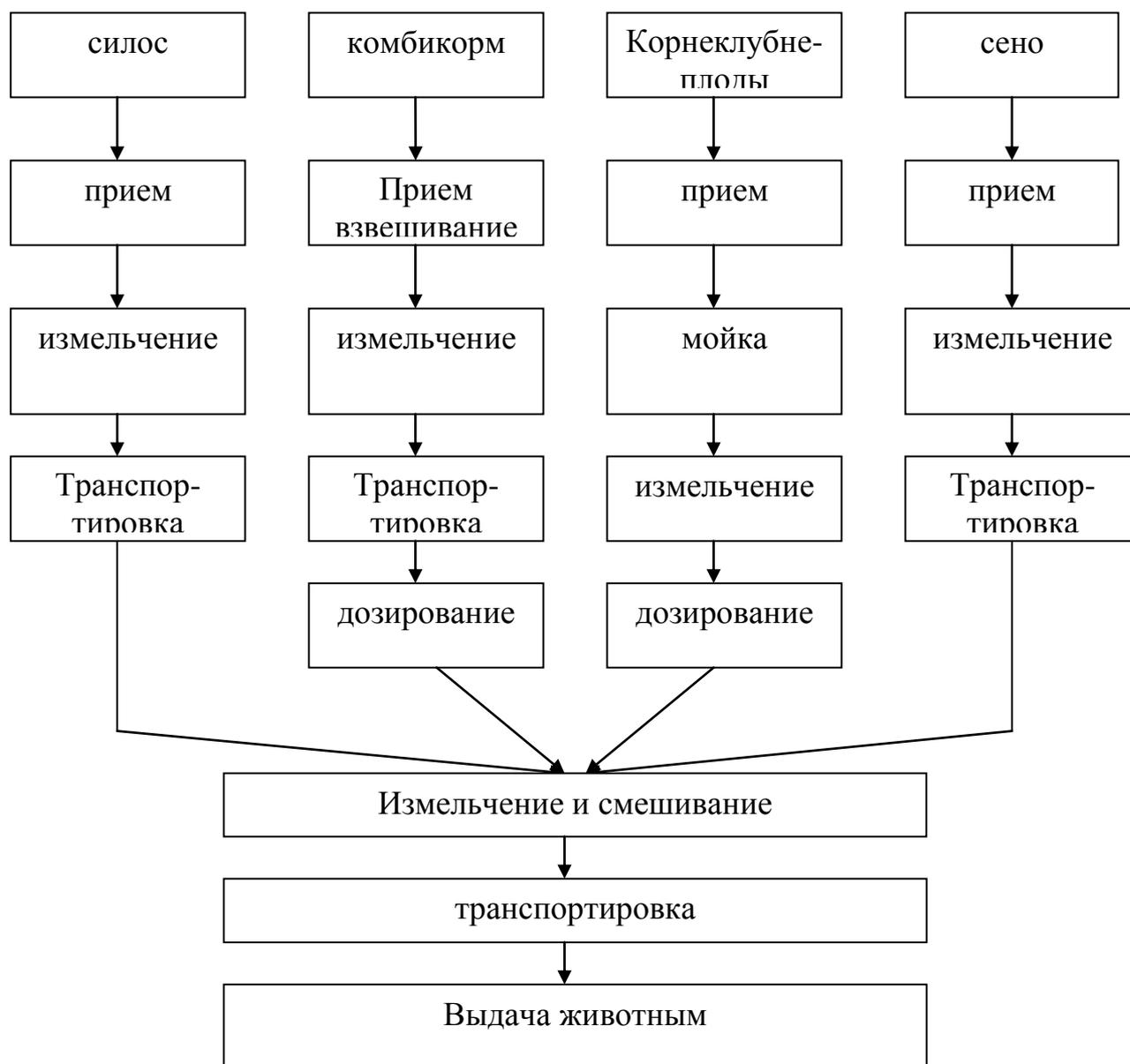
Рисунок 2.1 - Технологическая схема кормоцеха.
