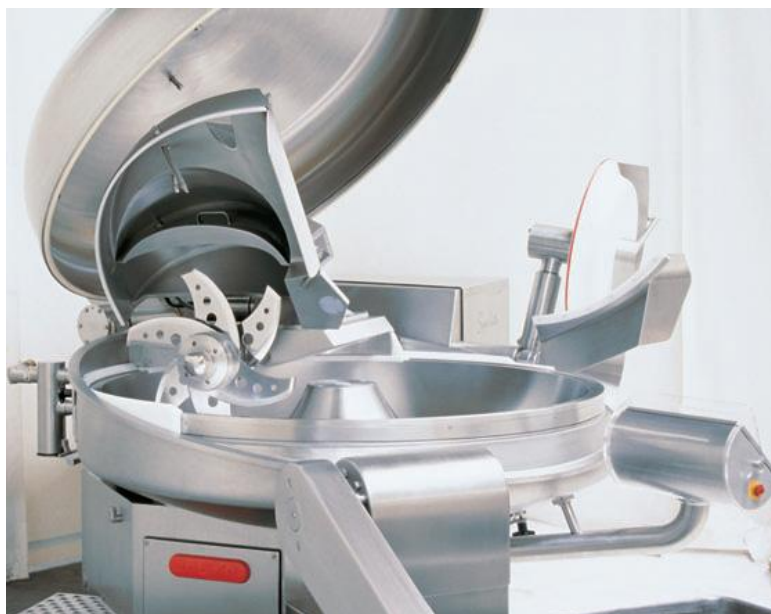
Рисунок 3- Вакуумный куттер «Laska»KUX 50 V.
