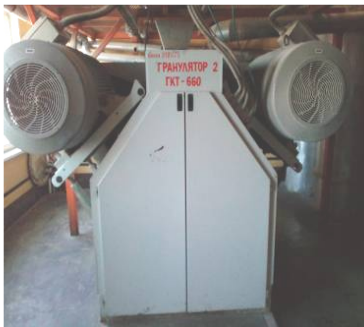
Рисунок 7 - Пресс-гранулятор ГКТ-660 (Г-2)
