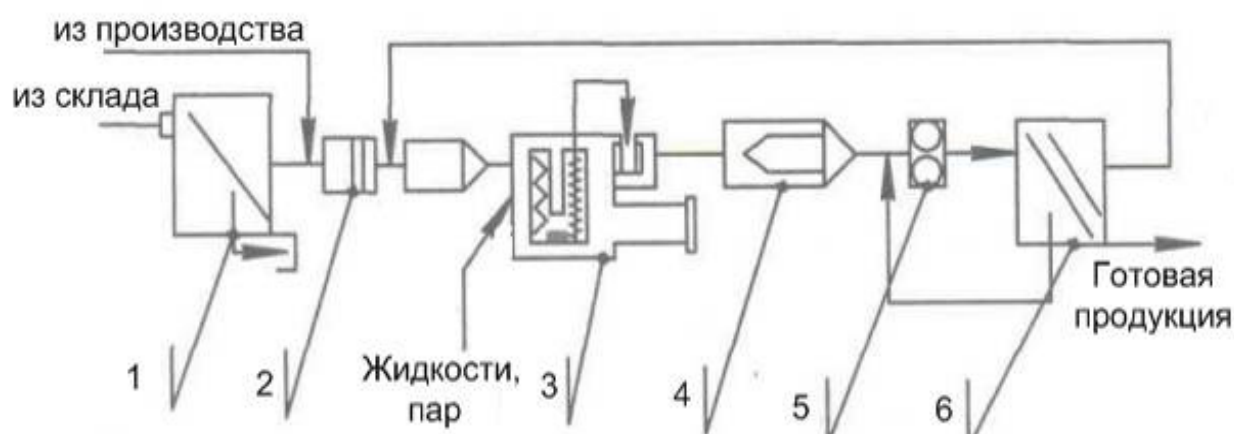
Рисунок 2 - Схема технологической линии гранулирования комбикормов:
