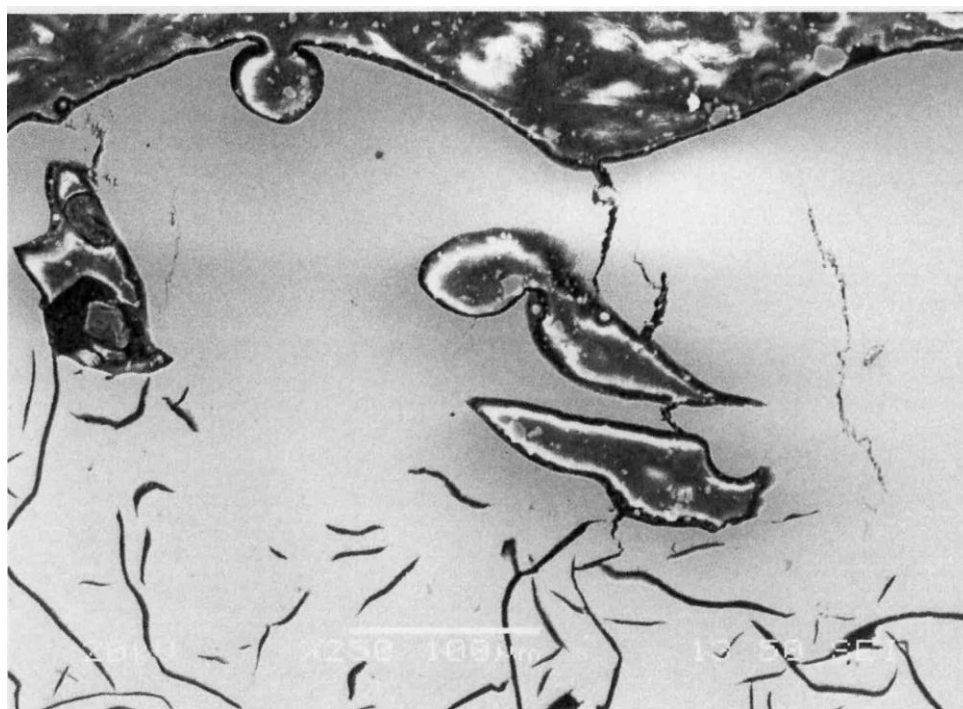
Рисунок 4.3 - Белый слой с увеличением \times 200 (а) и \times 250 (б)
