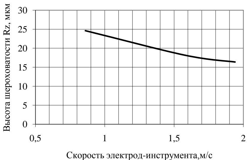
Рисунок 2.6 - Зависимость высоты шероховатости Rz от скорости движения бруска.
