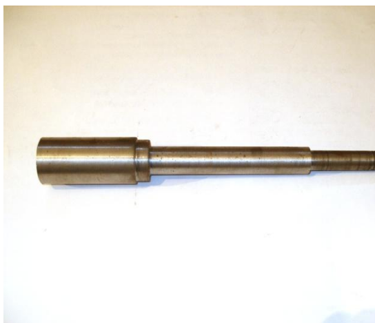
Рисунок 3.3 –Оправка для токарной обработки хонинговальных брусков
