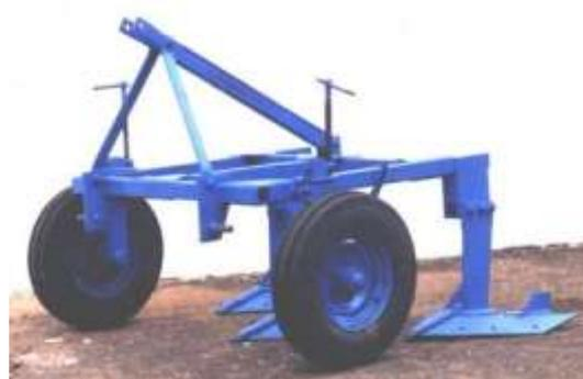
Рис.1.2. Общий вид культиваторов-плоскорезов
