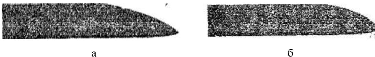
Рис. 1.9. Конфигурация лезвия изношенной плоскорежущей лапы
