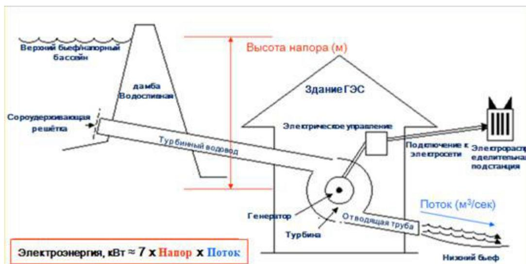
Рисунок 1.1 -- Принципиальная схема ГЭС
