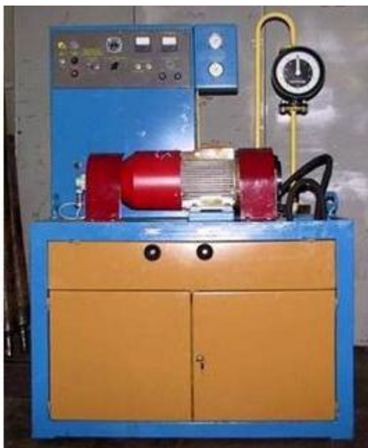
Рисунок 1.1. Стенд для обкатки и испытания компрессоров А2358
