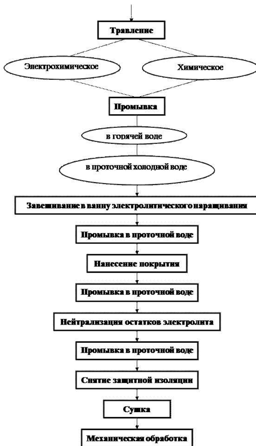
Рисунок 3.3 - Структурная схема технологического процесса.
