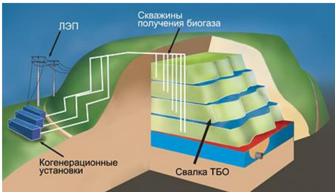
Рисунок 2.5 – Принципиальная схема комплексного решения энергоснабжения с использованием биогаза
