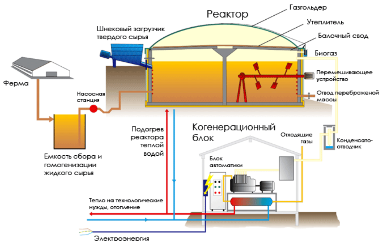
Рисунок 2.1 – Схема биогазовой установки
