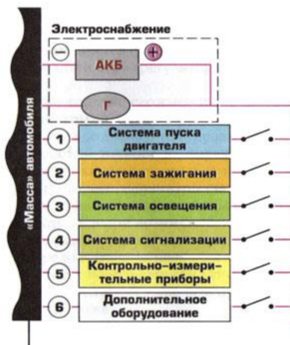
Рисунок 1.1- Принципиальная схема электрооборудования автомобиля
