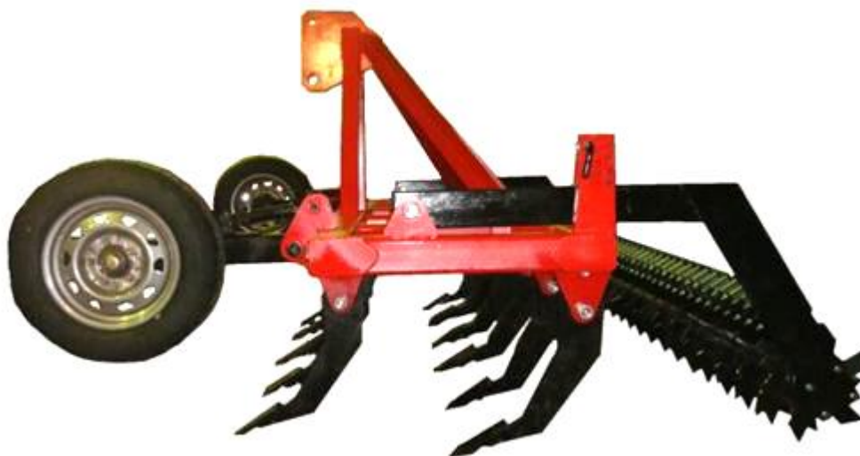
Рисунок 1.3 – Чизельный плуг ПЧН-3,4x2
