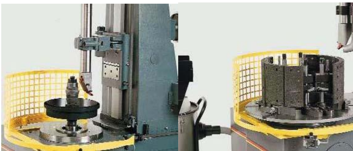
Рисунок 3.3 - Универсальный вертикальный станд для расточки и шлифовки тормозных барабанов, тормозных дисков, маховиков, тормозных накладок, головок цилиндров и многих других изделий HUNGER U305
