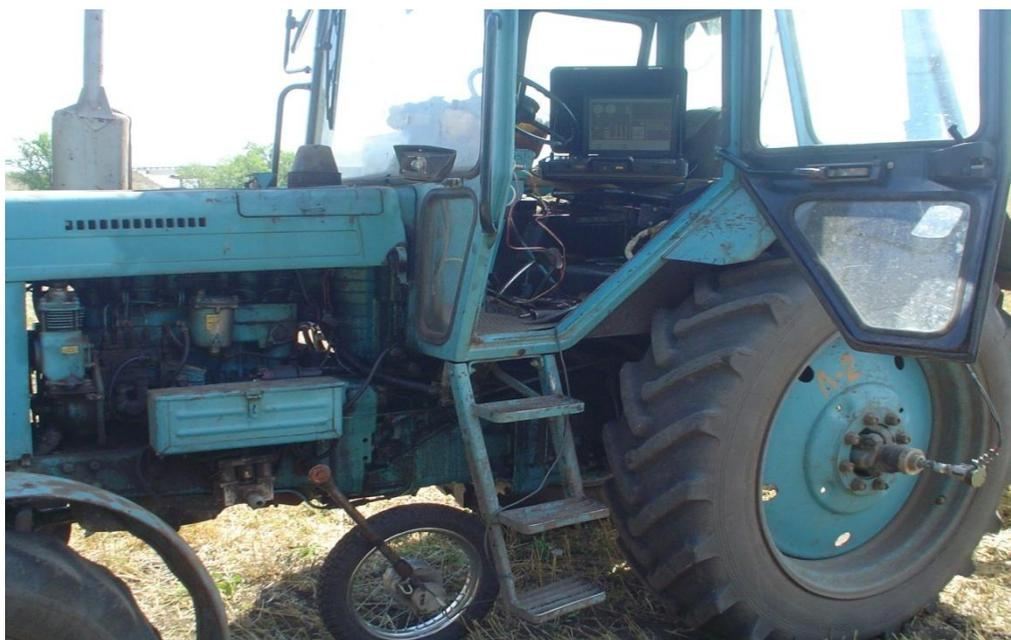
Рисунок 3.5. – Установка информационно-измерительной системы ИП-238 на энергетическом средстве
