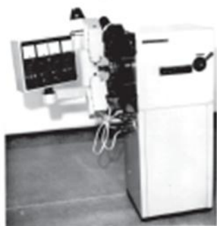
Элитрон-120А (упрочнение режущих инструментов осевой формы типа сверл, разверток)
