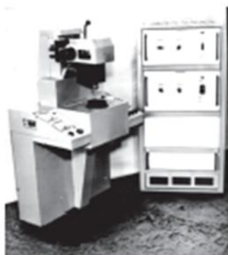
Элитрон-502А (упрочнение твердосплавных волок)
