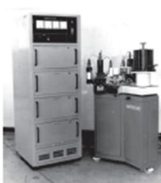
Элитрон-240А (серебрение электрических контактов)
