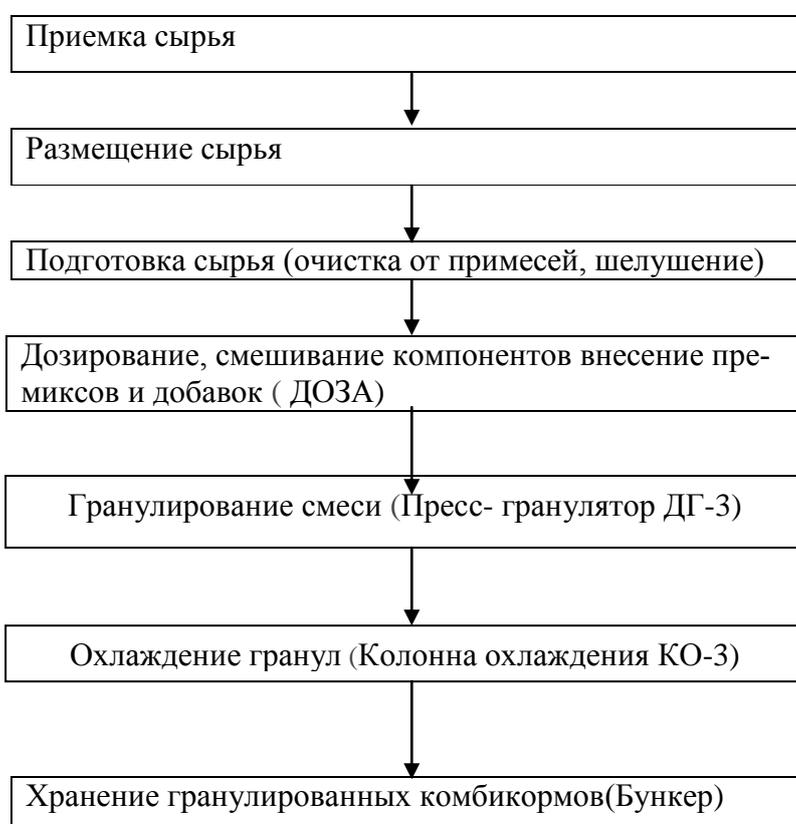
Рисунок 3 - Блок –схема производства комбикорма
