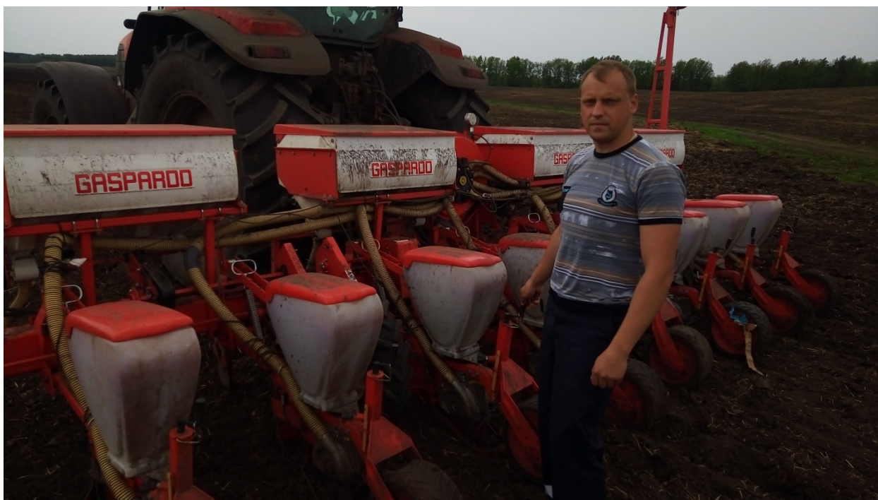
Рис.4. Посев гибридов кукурузы восьмирядной пневматической сеялкой GASPARDO
