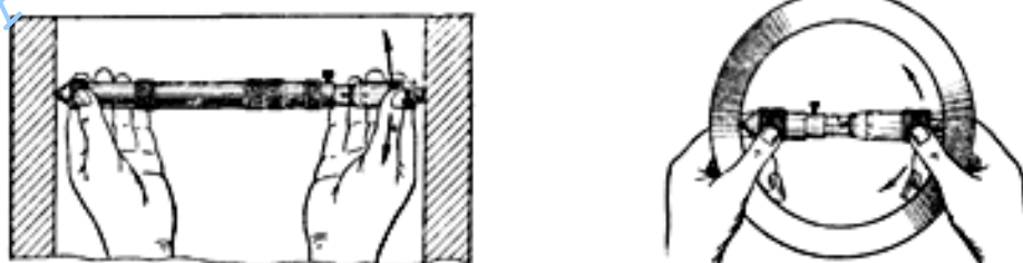
Рисунок 1.22 - Измерение микрометрическим нутромером
