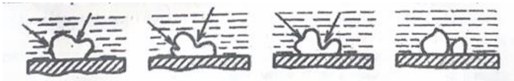
Рисунок 1. Схема гидравлических ударов при сокращении кавитационного пузыря
