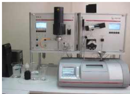
Рисунок 1 – Получение дигератов из сахарной свеклы на линии Venema avtomatic (а) и определение технологических показателей корнеплодов на линии Betalyser (б)
