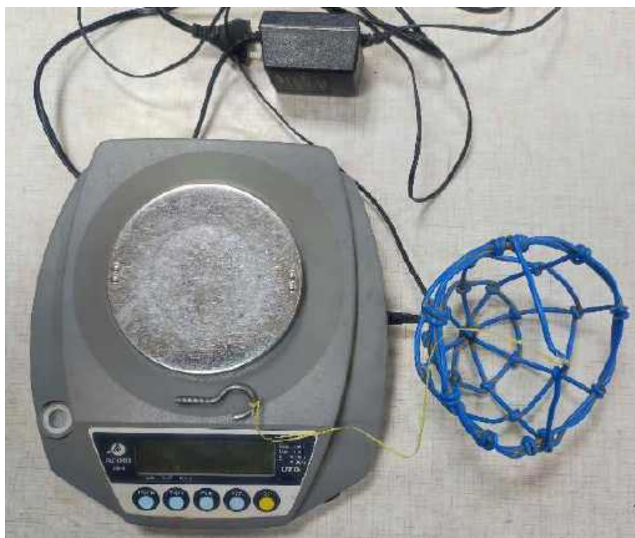
Рис. 22. Высокоточные весы и корзина с крюком для определения содержания крахмала
