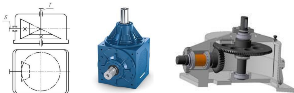
Рисунок 1.13 - Одноступенчатый конический редуктор с вертикальным ведомым валом
