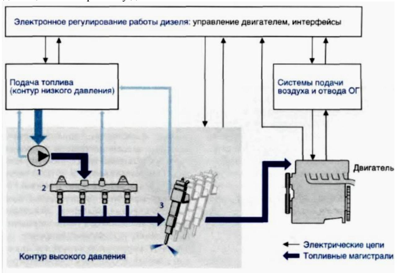
Рисунок 7 – **Принципиальная схема управления работой дизеля с аккумуляторной системы впрыска Common Rail:**
