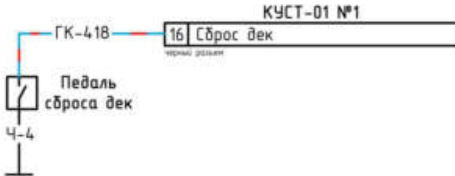
При поступлении команды «Сбросить деки» формируются команды на увеличение зазора деки молотильного и сепарирующего барабанов в течении **5 сек**
