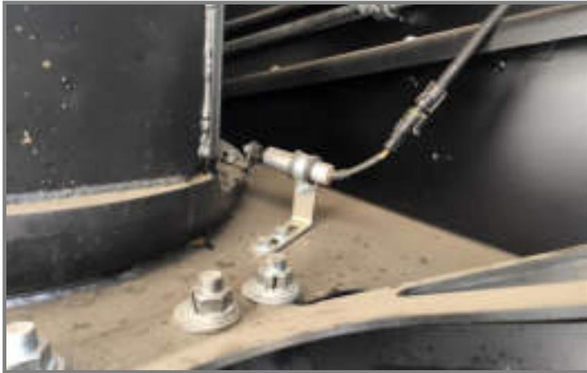
Отключение выгрузки автоматически при срабатывании датчика
