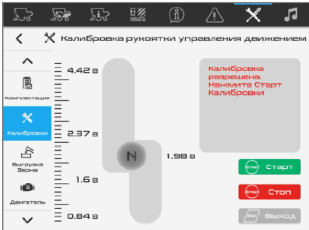
При проведении калибровки следуйте подсказкам на мониторе МСМ-01
