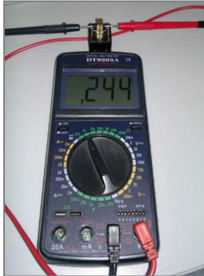
Пример измерения сопротивления обмотки реле
