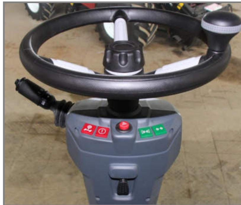
**Включение транспортного освещения возможно только после включения клавиши габаритного освещения!**
