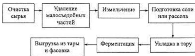
Технологическая схема квашеных, соленых плодов и овощей
