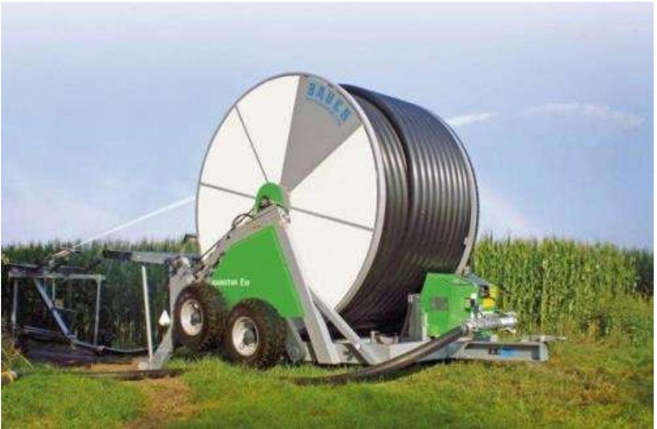
Рис. 18. Барабанные дождевальные машины BAUER
