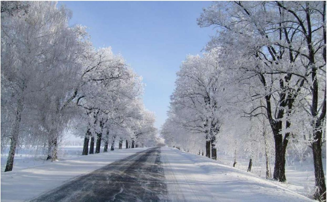
Рис.21. Лесные полосы для защиты дорог от снежных заносов
