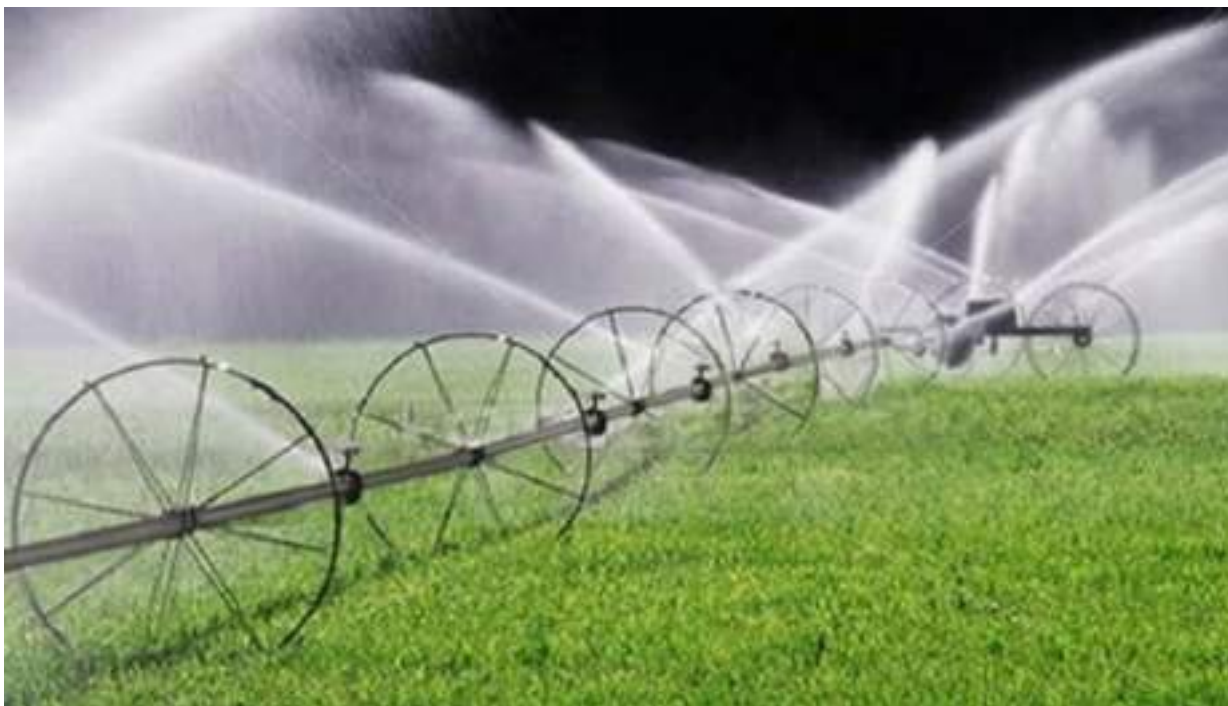
Рис13 . Дождеватель колесный широкозахватный ДКШ-64 «Волжанка»
