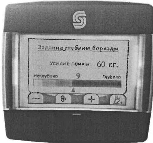
чтобы минимизировать работу оператора, максимально ускорив процесс настройки. Инновационная технология ALIVE позволяет уйти от традиционного понятия «глубина заделки семян» и работать с толщиной слоя почвы над семенами.
