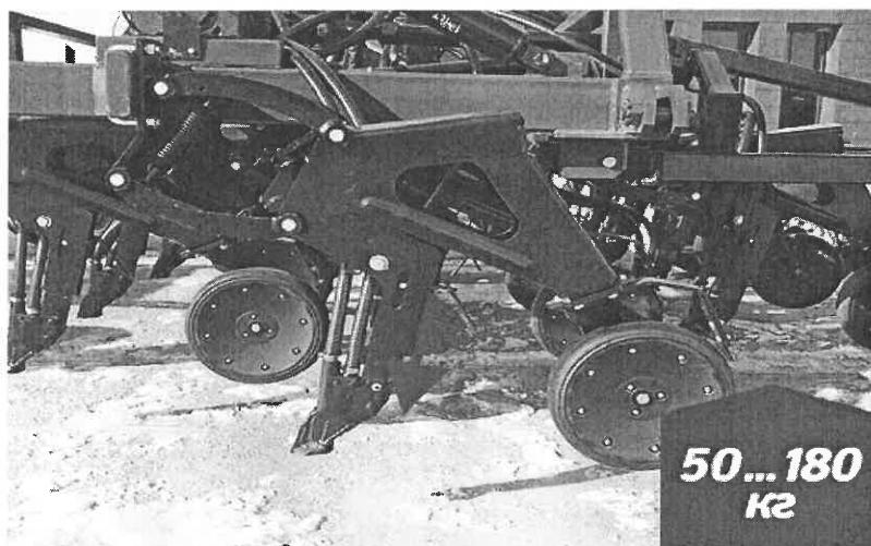
автоматическом режиме поддерживать силу прикатывания, величина которой зависит от размера семян. За счет использования анкерного рабочего органа аграрии получат возможность
