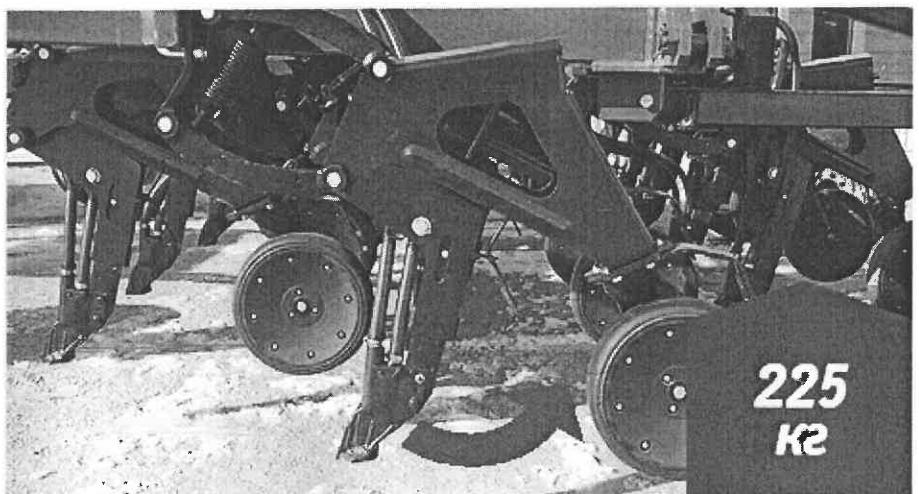
препятствие сошник может отклоняться вверх, что предупреждает его поломку.
