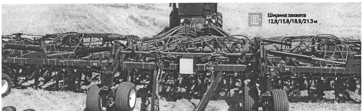
Рабочие органы расположены в три ряда, расстояние между рядами – 980 мм, между стойками в ряду – 254 или 305 мм, между стойками в разных рядах 762мм. Прижимное усилие на катках варьируется в пределах 68–226 кг. Пружина сошника работает на растяжение, усилие ее срабатывания – 225кг.
