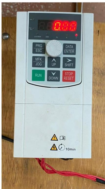
Рисунок 3.1 – Частотный регулятор серии FST-631
