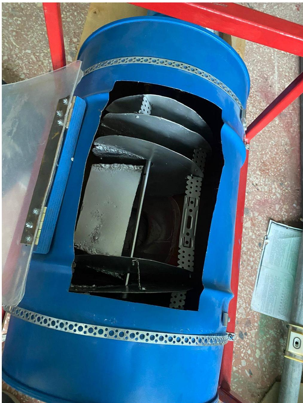
Рисунок 4.3 – Экспериментальная лабораторная установка с определения однородности смеси.
