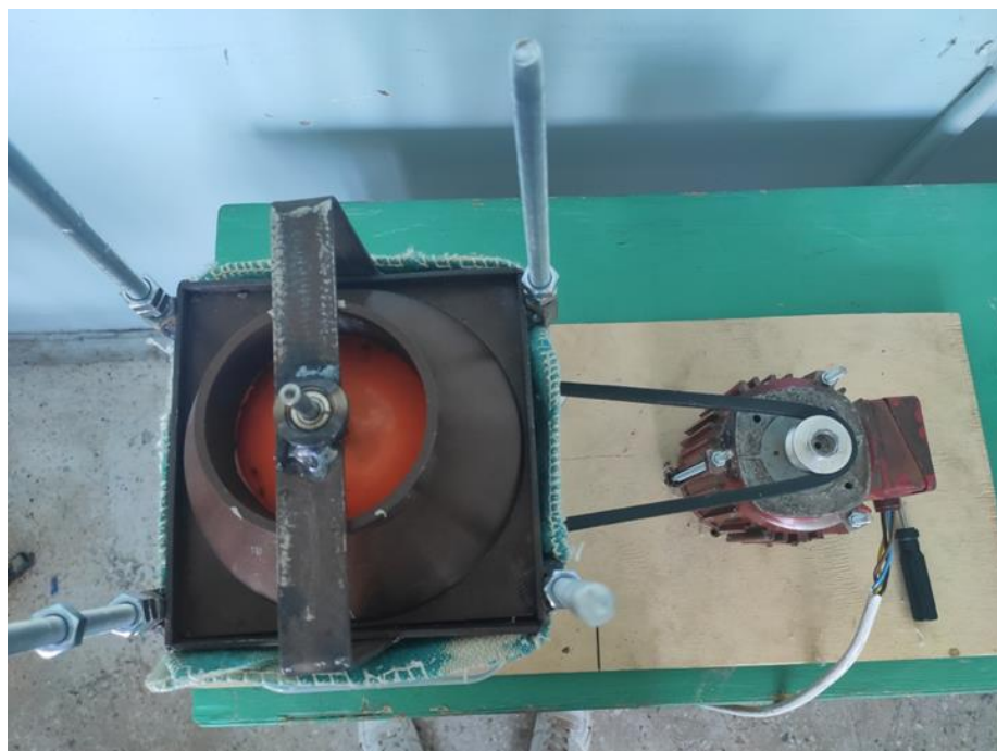
Рисунок 3.5 – Вид сверху на устройство для шелушения зерна гречихи с полусферическим рабочим органом.
