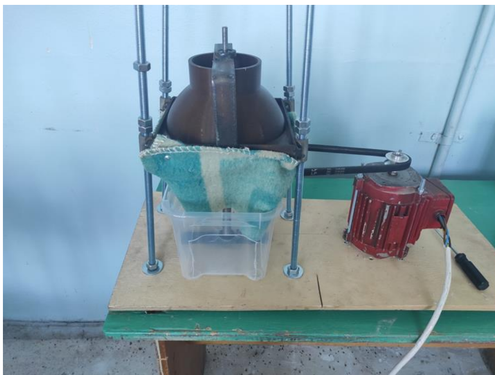
Рисунок 3.4 –Общий вид устройства для шелушения зерна гречихи с полусферическим рабочим органом.
