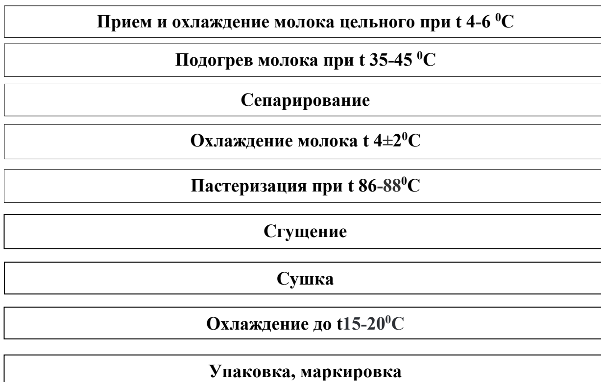
Рисунок2 -Технологическая схема процесса производства сухого обезжиренного молока
