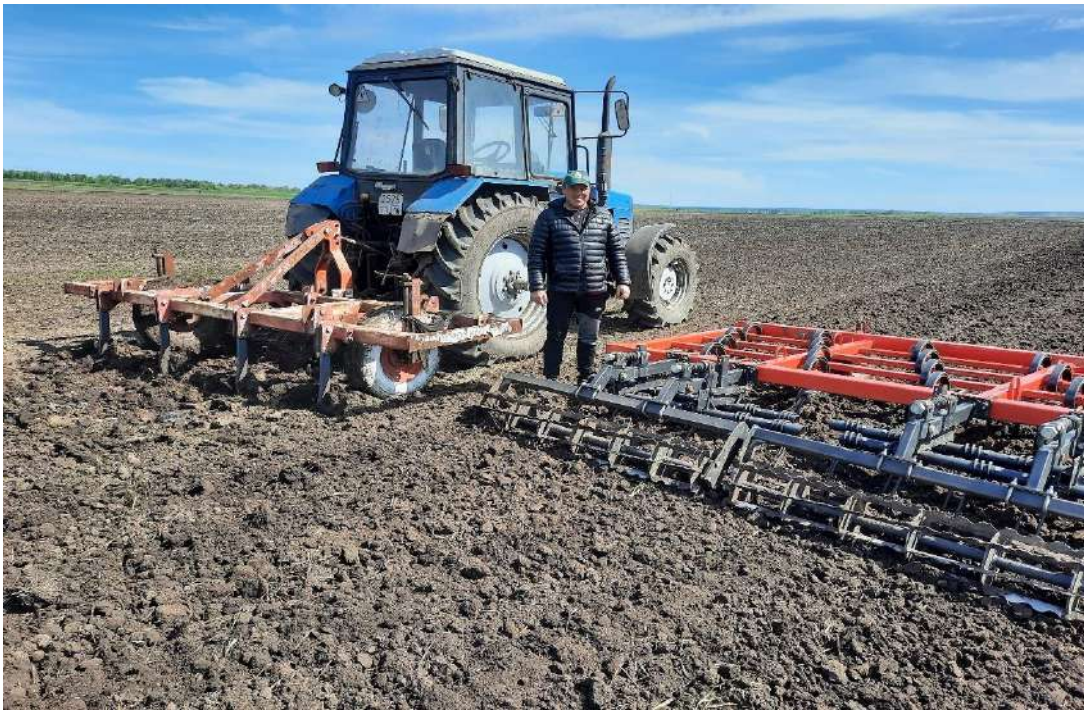
Фото1. Предпосадочная подготовка почвы 5 мая 2023. МТЗ 1221+КСН-3,4 и МТЗ 1221+КПС-8
