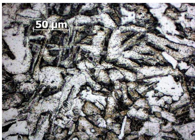
Рисунок 4.12 – Структура подложки Сталь 65Г
